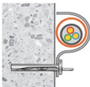
Рисунок 1 - Монтаж ОКЛ при помощи дюбеля и самореза к поверхности из кирпича/бетона
