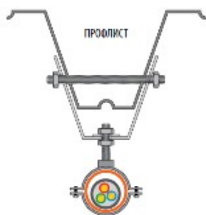
Рисунок 8 - Монтаж ОКЛ в обхват горизонтальных металлических конструкций
