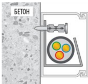
Рисунок 12 - Монтаж ОКЛ в кабельном канале при помощи дюбель-гвоздя для газового монтажного пистолета к поверхности из кирпича/бетона
